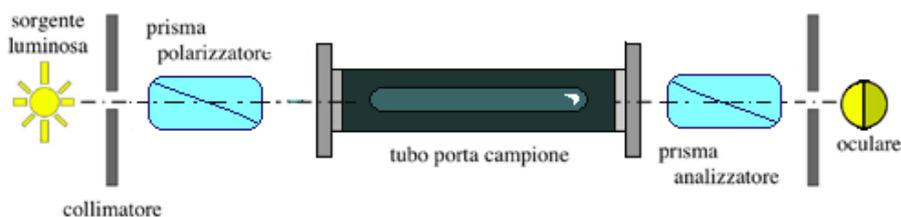
Figura 5.3: Schema generale di un polarimetro.
