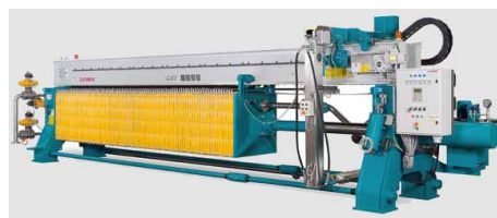
Figura 4.117: Foto di una pressa per filtrazione a telai e piastre.
