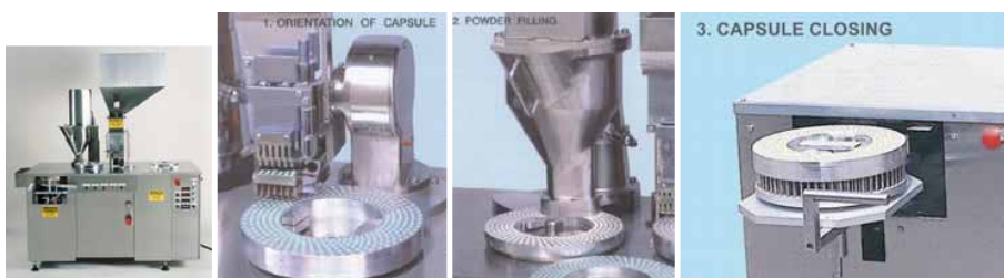
Figura 1.23: Foto di un apparato di riempimento a coclea.
