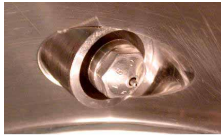
Figura 4.47: Ugello per granulatori tangenziali: presenti l'ugello per liquidi e la corona per le polveri.
