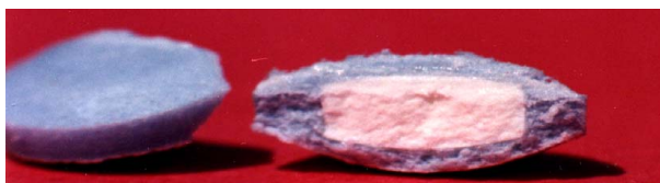
Figura 4.93: Compressa ottenuta per doppia compressione.
