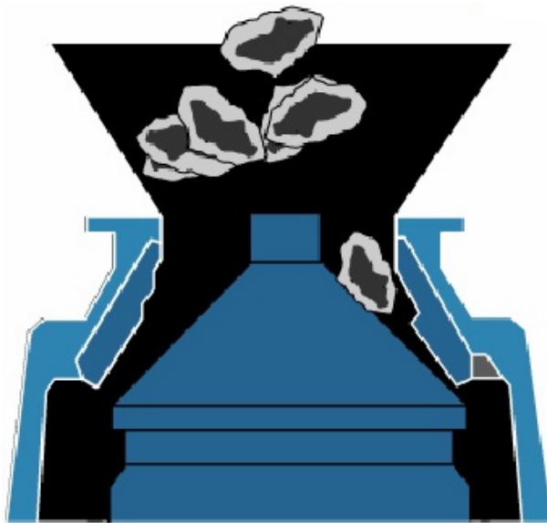
Figura 4.5: Schema di un frantumatore conico.
