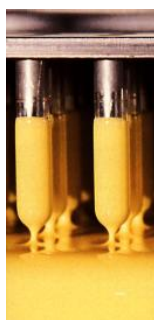
Figura 1.21: Immersione degli stampi nella soluzione di gelatina fusa.
