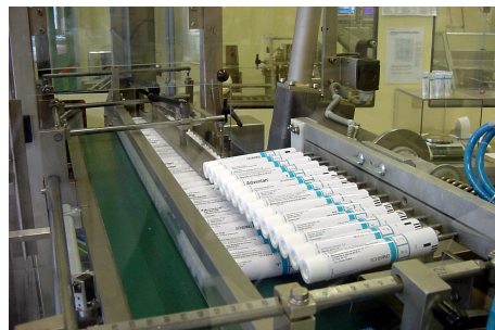
Figura 2.9: Riempimento dei tubetti di semisolidi.
